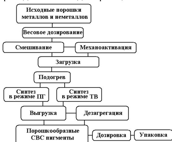
Рисунок 26 – Общая технологическая схема получения пигментов шпинельного типа
