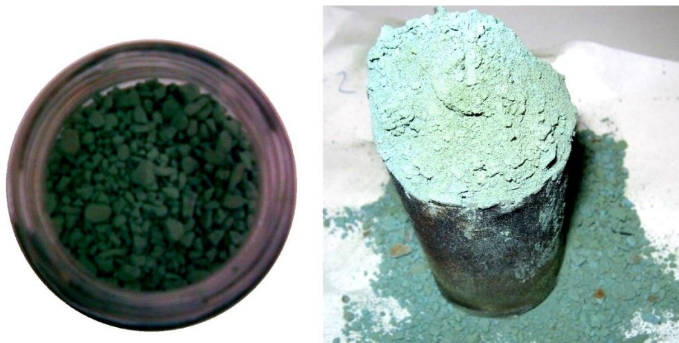
Рисунок 4.17 – Фотографии продуктов СВ-синтеза пигмента №52(OH) системы \text{ZnO-Ni}_2\text{O}_3\text{-Cr}_2\text{O}_3\text{-Al}_2\text{O}_3 на основе \text{Al(OH)}_3
