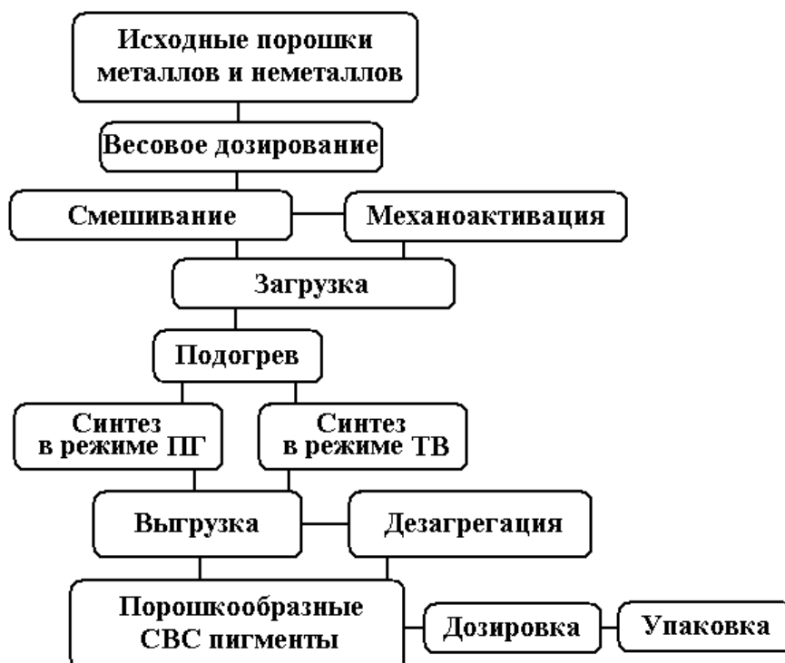
Рисунок 5.5 – Технологическая схема получения пигментов шпинельного типа
