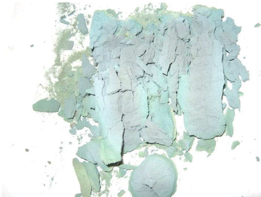
Рисунок 5.3 – Фотография пигмента №52 системы \text{ZnO-Ni}_2\text{O}_3\text{-Cr}_2\text{O}_3\text{-Al}_2\text{O}_3
