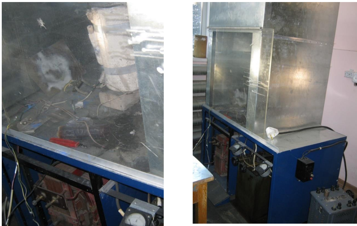
Рисунок 5.8 – Вытяжной шкаф с трансформатором тока и печью сопротивления для образцов диаметром 60–80 мм
