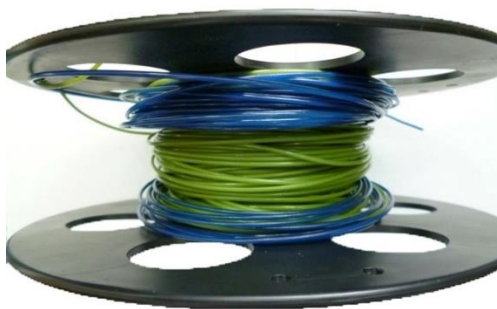
Рис. 5.11 – Пруток, основа – полимер SBS (99 мас. %) и пигмент (1 мас. %)
