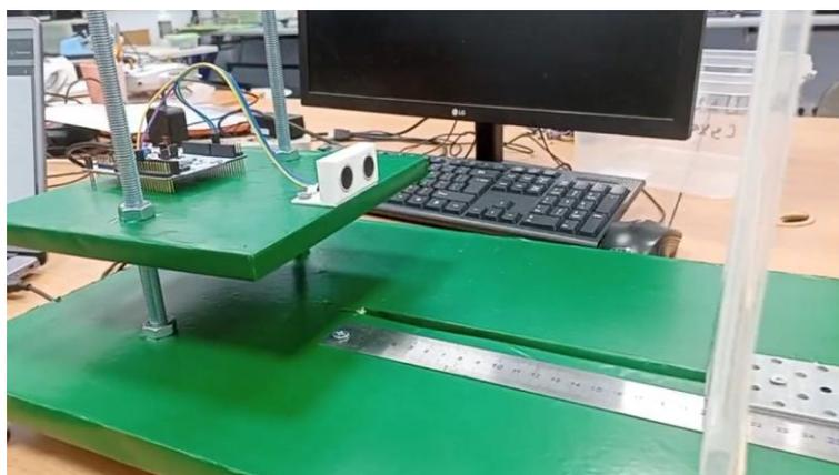
*Рис. 5. Стенд для определения погрешностей измерения расстояний с помощью ультразвукового дальномера*
