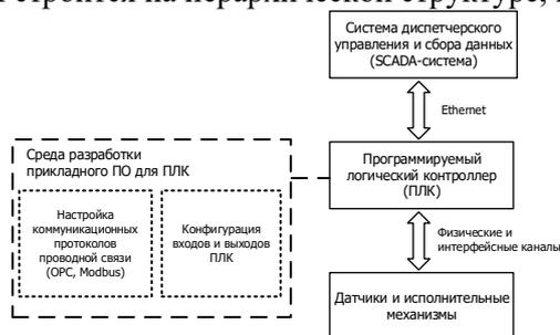
Рис. 1. Структурная схема традиционной АСУ ТП
