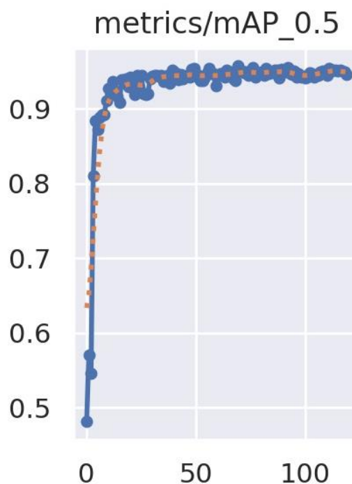
Рис. 5. Зависимость значения метрики mAP 0.5 от количества эпох обучения для модели YOLOv5x, batch_size =8
