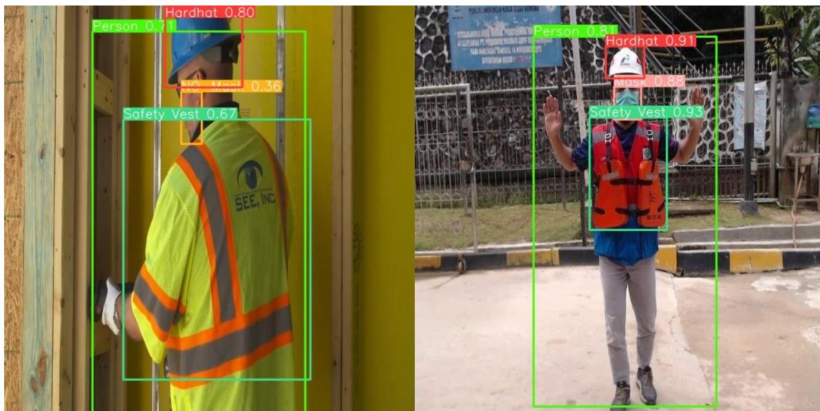
Рис. 3. Классификация объектов на изображениях с помощью модели YOLOv8 Nano
