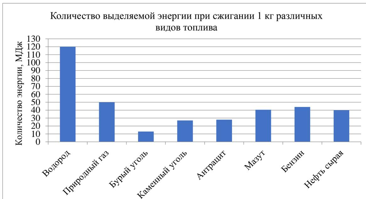
Рис. 1. Сравнительная диаграмма количества энергии, получаемого при сжигании единицы массы различных типов горючего
