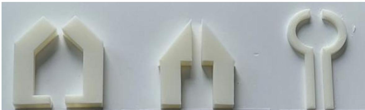
*Рис. 2. Разработанные модели наноантенн:
