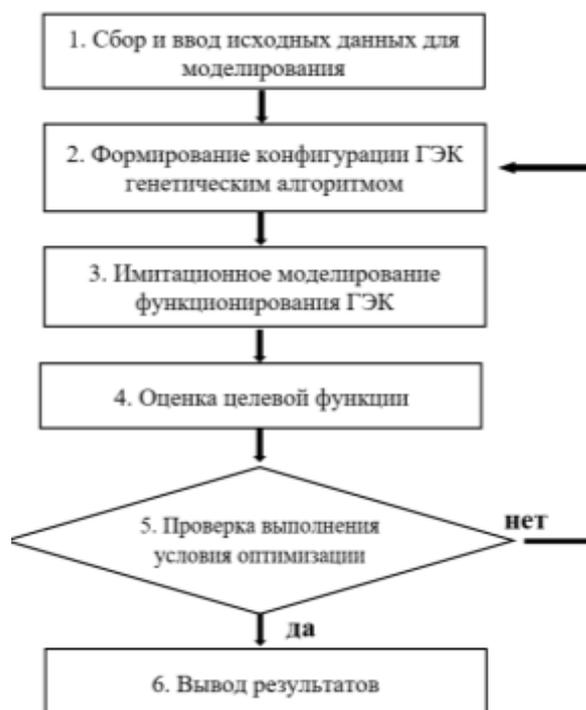
Рис. 1. Двухуровневая модель оптимизации конфигурации ГЭК
