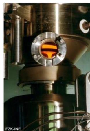
Рис. 2. Способ получения стеклянной матрицы для захоронения ВАО [4]
