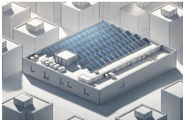
Рис. 1. Демонстрация влияния затенения от соседних зданий на эффективность работы солнечных панелей на крыше здания в городской застройке
