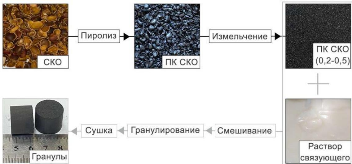
Рис. 1. Схема получения биоугольных гранул
