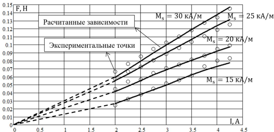
Рис. 5. Экспериментальные и рассчитанные зависимости выталкивающей силы  $F$  от тока возбуждения  $I$
