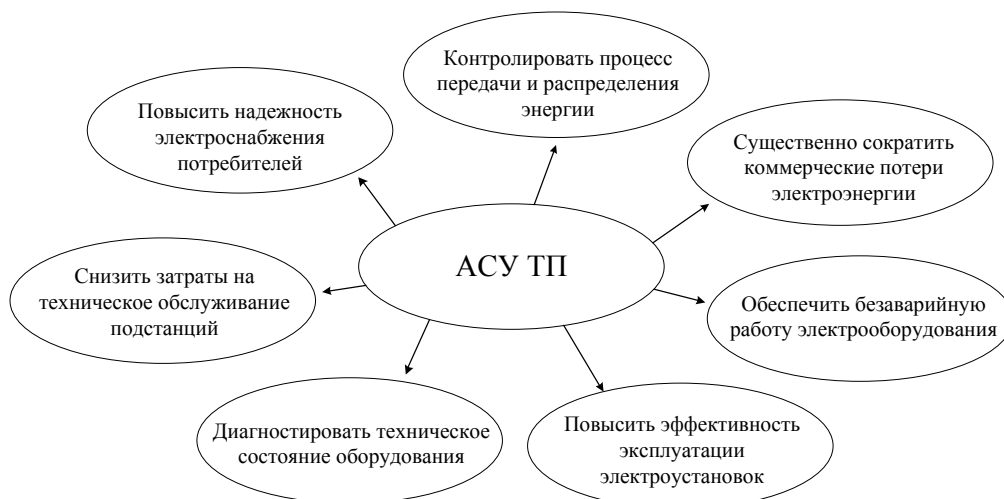
Рис. 1. Возможности АСУ ТП подстанций
