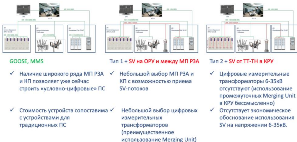
Рис. 1. Сравнение архитектур цифровых подстанций
