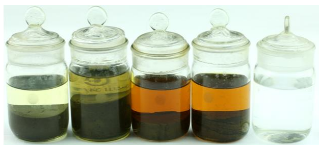
Рис. 3. Спиртбензольная вытяжка образцов породы пласта ПК22-2 (глубина отбора 1647,3–1650,5 м, Вынгапуровская скважина 614). Справа экспонируется бюкс с чистой спиртбензольной смесью Fig. 3. Alcohol-benzene extract of rock samples from the PK22-2 formation (sampling depth 1647.3–1650.5 m, Vyngapurovskaya well 614). Bunker with pure alcohol-benzene mixture is on the right
