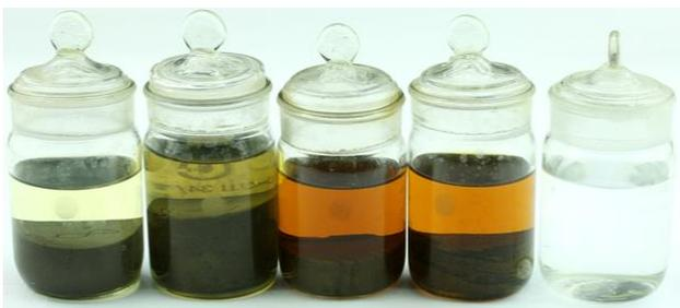
**Рис. 3.** Спиртбензольная вытяжка образцов породы пласта ПК22-2 (глубина отбора 1647,3–1650,5 м, Вынгапуровская скважина 614). Справа экспонируется бюкс с чистой спиртбензольной смесью
