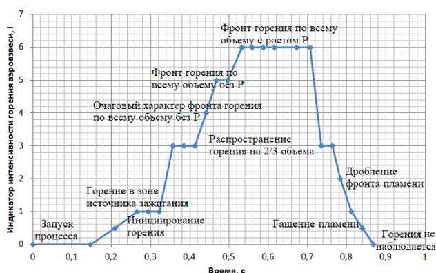
**Рис. 2.** Зависимость интенсивности взрывного горения аэровзвесей в реакционном объеме от времени протекания процесса
