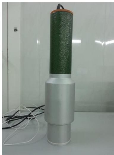
Рисунок 1.2 – Детектор на корпусе фотоэлектронного умножителя ФЭУ R7400
