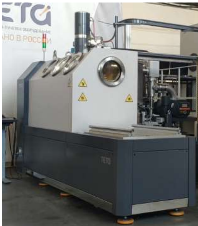
Рис. 2. Пример конструкции установки электронно-лучевой сварки, оснащенной свинцовыми смотровыми окнами
