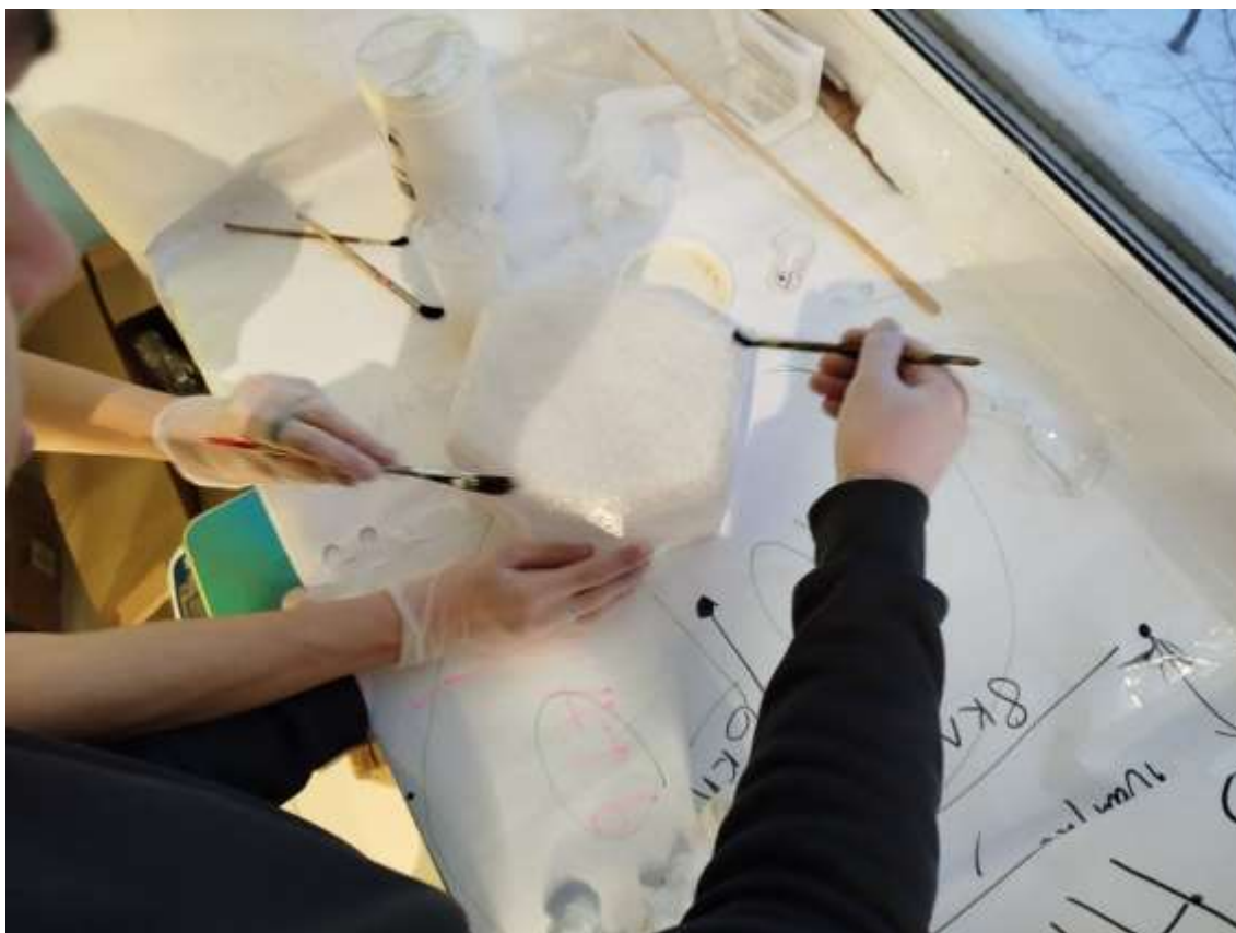
Рис. 3. Покрытие водонепроницаемых чехлов жидким силиконом
