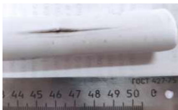
Рис. 1. Образец трубы с дефектом
