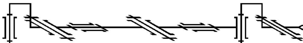
Рис. 2. Кинематическая схема руки робота гуманоида
