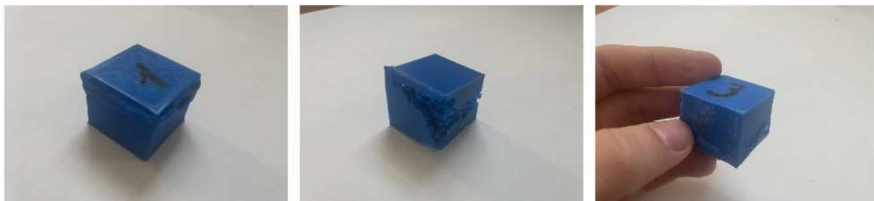
Рис. 4. Кубики из PETG пластика после проведения испытаний
