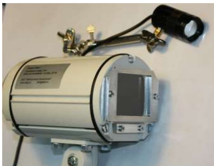
Рис. 1. Пример реализации видеокамеры с блоком подсветки
