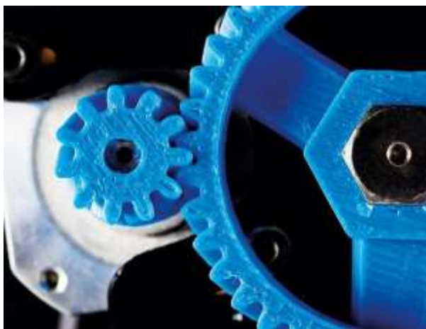
Рис. 1. Пример печати зубчатого зацепления на 3D-принтере
