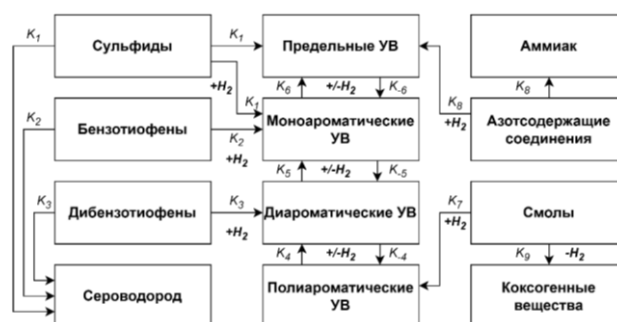
Рис. 1. Формализованная схема превращений в процессе гидроочистки вакуумного газойля
