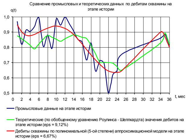
Рис. 5. Восстановление истории работы скважины по обобщенному уравнению Роулинса–Шеллхардта
