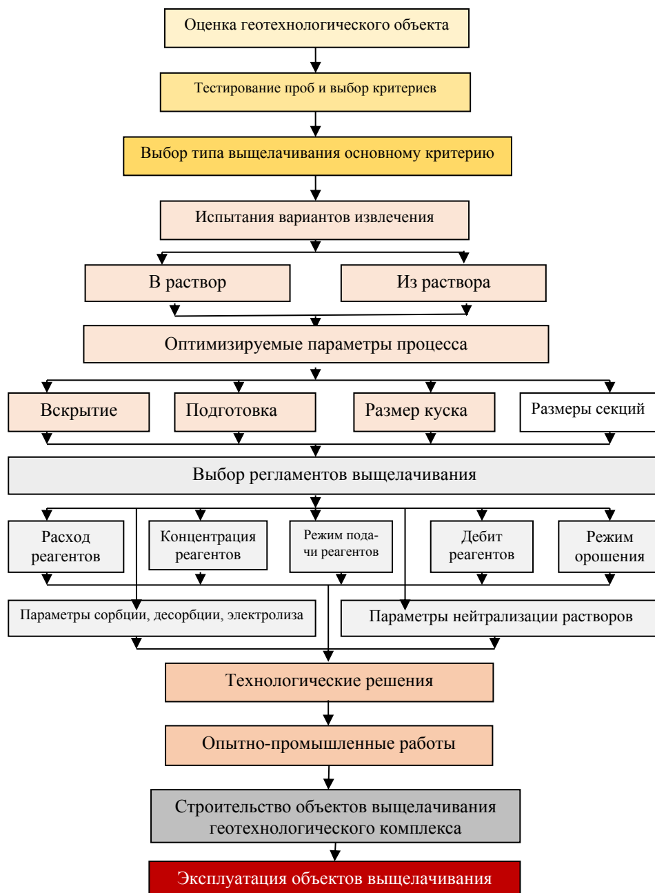
Рис. 2. Алгоритм выбора технологии выщелачивания из хвостов и бедных руд
