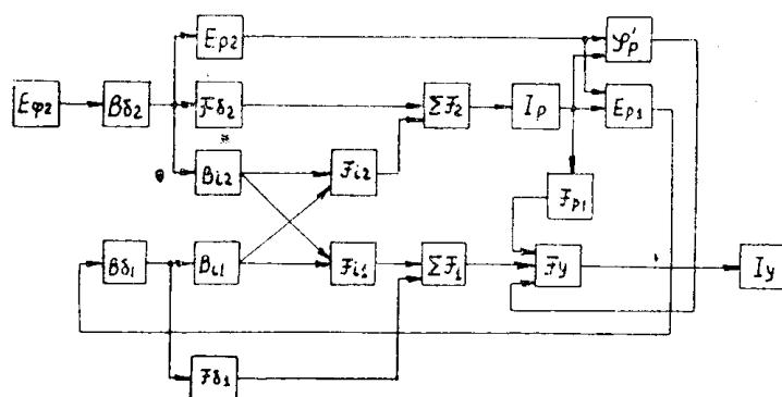
Рис. 2. Структурная схема расчета характеристики х.х. совмещенного ЭМУ.
