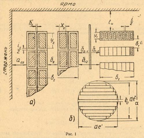
a — эскиз осевого сечения фазы;  $\delta$  — эскиз сечения стержня трансформатора.
