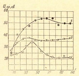
Рис. 3. Зависимость напряжения перекрытия от числа разрядов по поверхности составных и простых диэлектриков: 1 — составной диэлектрик КJ+NaCl, где КЈ примыкает к катоду, NaCl — к аноду; 2 — составной диэлектрик КЈ+NaCl, где NaCl примыкает к катоду, КЈ — к аноду; 3 — NaCl
