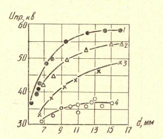
Рис. 2. Зависимость напряжения перекрытия от межэлектродного расстояния для кристаллов разного химического состава: 1 — NaCl; 2 — KCl; 3 — KBr; 4 — KJ
