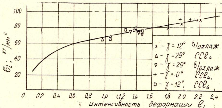
Рис. 1. Связь между интенсивностью напряжений и интенсивностью деформаций в процессах сжатия и резания на микроскорости
