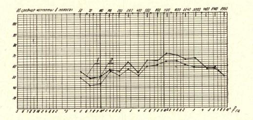
Рис. 2. Спектрограммы воздушного шума электродвигателя AO2-32-2 при U=380  $\theta$ , c. ф. — Y, f=50  $\varepsilon\mu$ . I — с вентилятором основного исполнения (3 лопатки), I — с вентилятором тарельчатого типа (6 лопаток)
