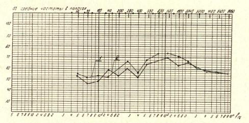
Рис. 1. Спектрограммы воздушного шума электродвигателя AO2-42-2 при U=380 в, с. ф. — Y, f=50 гц. I — с вентилятором основного исполнения (3 лопатки), 2 — с вентилятором тарельчатого типа (8 лопатки)
