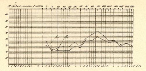
Рис. 3. Спектрограммы воздушного шума электродвигателя AO2-21-2 при U=380  $_{\it 6}$ , с. д. — Y, f=50  $_{\it 24}$ , 1 — с вентилятором основного исполнения (3 лопатки), 2 — с вентилятором тарельчатого типа (8 лопаток)
