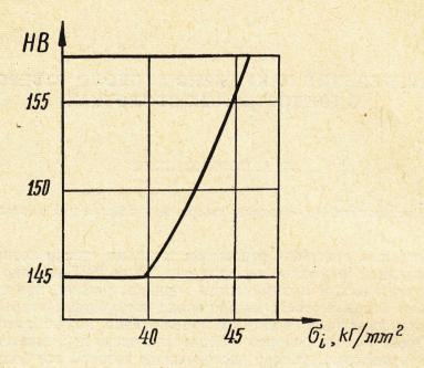
Рис. 1. Тарировочный график: твердость H— интенсивность напряжений σ<sub>i</sub>.
