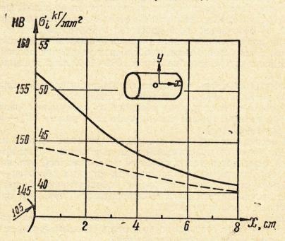
Рис. 2. Изменение твердости и интенсивности напряжений у отверстия по осевому сечению оболочки
