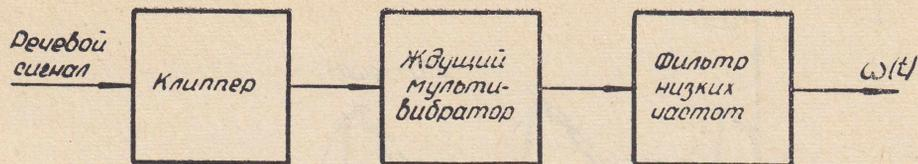
Рис. 1. Анализатор мгновенной частоты речевого сигнала
