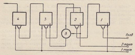
Рис. 5. Счетчик со сбросом за счет процесса счета. Вторая модификация
