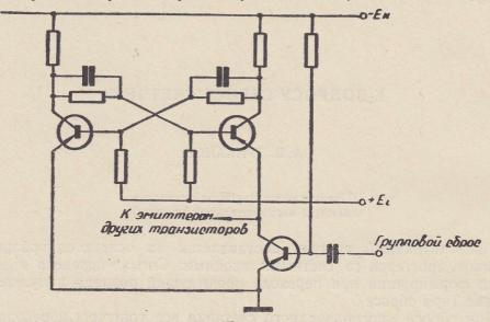
Рис. 2. Групповой сброс с помощью деполнительного транзистора
