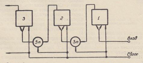
Рис. 6. Счетчик со сбросом за счет использования элементов запрета
