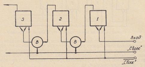
Рис. 7. Счетчик со сбросом за счет использования вентилей.
