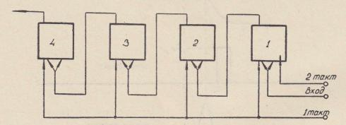
Рис. 3. Счетчик со сбросом за счет процесса счета
