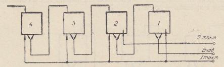
Рис. 4. Счетчик со сбросом за счет процесса счета. Первая модификация
