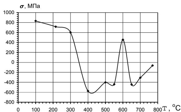
Рис. 2. Изменение внутрискрутурных напряжений материала трубы из ст 10 в зависимости от температуры
