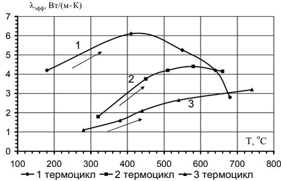
**Рис. 3.** Характер изменения эффективной теплопроводности материала стенки трубы из стали 0X18H10T в первых трех термоциклах для  $\delta_{ст}=3,8$  мм
