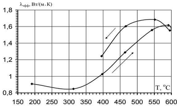
**Рис. 4.** Температурный гистерезис эффективной теплопроводности материала трубы толщиной 5 мм из стали 12X1MФ
