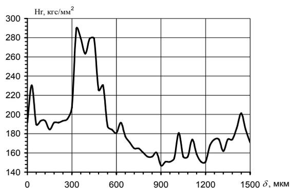
Рис. 6. Изменения микротвёрдости по толщине стенки материала трубы (начиная с наружной стороны), изготовленной из ст10
