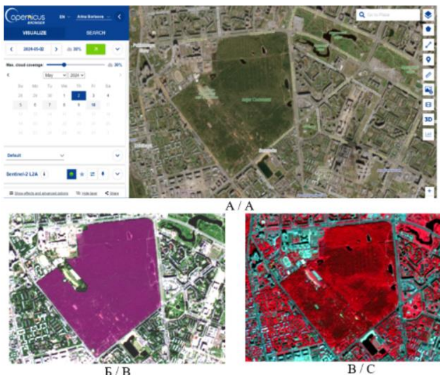
Рис. 1. Этапы обработки космоснимков: А) выбор территории и установление необходимых параметров; Б) оцифровка границ парка Сосновка; В) синтез спектральных каналов NIR-Red-Green Fig. 1. Stages of satellite image processing: A) selection of territory and establishment of necessary parameters; B) digitization of the boundaries of Sosnovka Park; C) synthesis of NIR-Red-Green spectral channels
