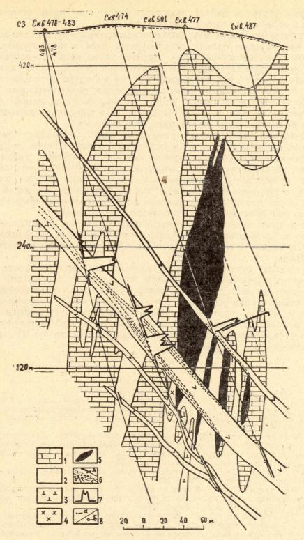
гис. 1. Ксеногенные струи в дайках диабазового порфирита, секущих магнетитовые рудные тела. Месторождение Северный Аргыш-Таг, разведочный разрез 1. (По материалам Казской экспедиции ЗСГУ 1960 г. с дополнениями Е. В. Ярошинского)
