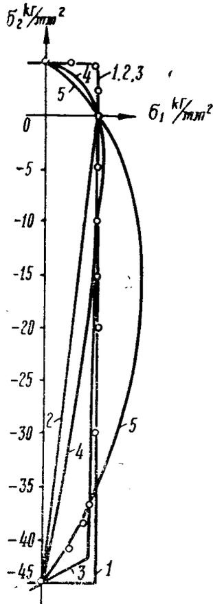
Рис. 1. Контуры прочности для стекла по различным теориям: 1—наибольших нормальных напряжений; 2—упрощенному критерию Мора; 3—обобщенной наибольших деформаций; 4—по Миролюбову; 5—по Баландину; о — опыт
