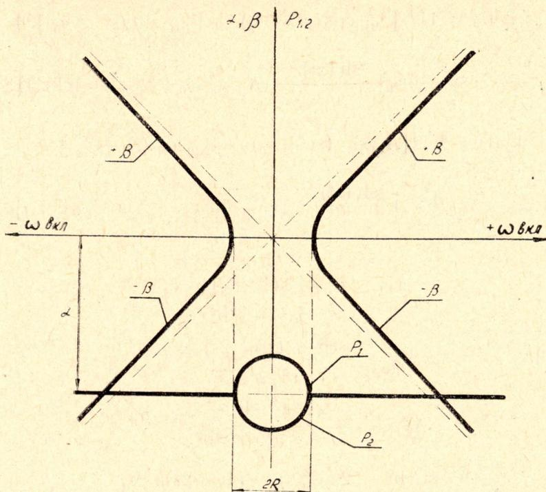
Рис. 1. Зависимость корней характеристического уравнения от скорости включения
