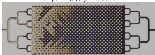
Микрофлюидный чип для моделирования осаждения асфальтенов в прискважинной зоне
