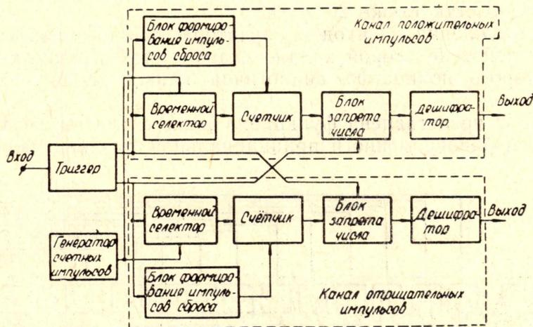
Рис. 1. Блок-схема анализатора клипированной речи
