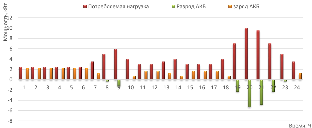
Рисунок 7 – Диаграмма энергетического баланса автономной системы электроснабжения с инверторной микроГЭС
