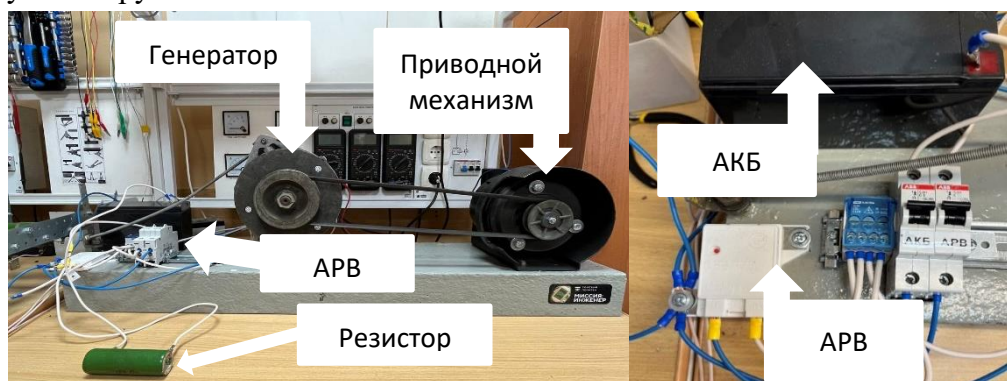
Рисунок 5 – Экспериментальный стенд для исследования работы аккумуляторов в цепи постоянного тока инверторной микроГЭС.
