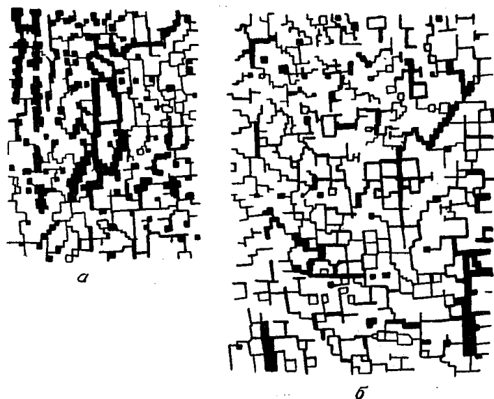
Рис. 1. Блочное строение кристаллов галоида натрия (калия): а) блочное строение торцевой части кристалла (100); б) блочное строение одной из призматических граней того же кристалла. Черные линии-границы блоков, щели, пустоты, не занятые кристаллами солей
