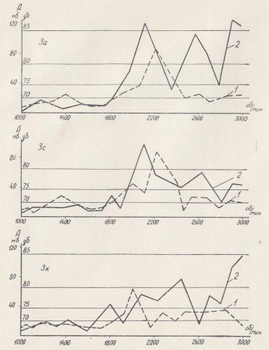
Рис. 3. Виброграммы участков, расположенных по длине станины по линии главных полюсов: 1 — скос зубцов «елочкой», 2 — линейный скос
