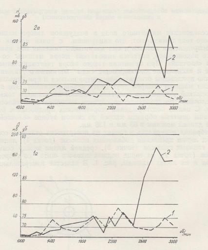
Рис. 2. Виброграммы участков станины, соответствующих точкам 1 и 2: 1 — скос зубцов «елочкой», 2 — линейный скос
