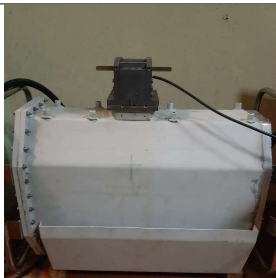
Рисунок – 3.2 коллимационная система с РАП-300-5
