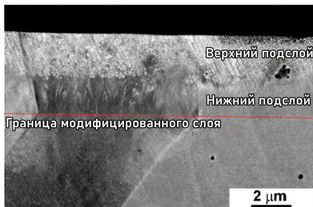
Рис. 1. РЭМ снимок поперечного сечения Ni_3Al после трех циклов нанесения TiC
