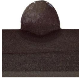
Рис. 1. Поперечный шлифы выращенного валика
