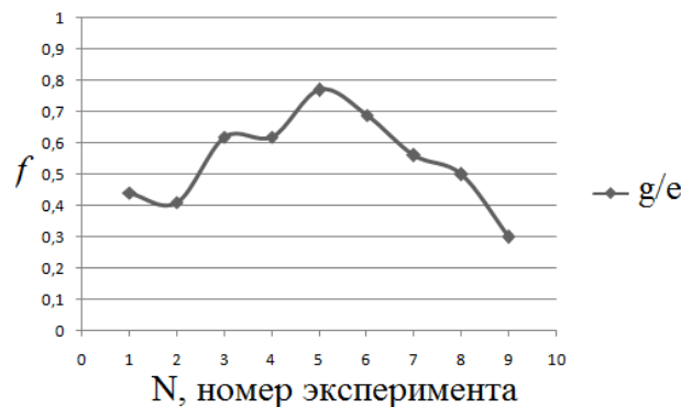
Рис. 3. График отношения высоты усиления валика к ширине валика
