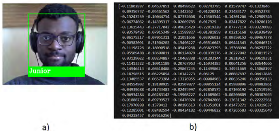
Рис. 2. Процесс генерации эмбеддинга лица: а) детекция и распознавание лица; б) сгенерированный эмбеддинг
