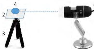
Рис. 2. Схемы устройств для измерения угла смачивания:
