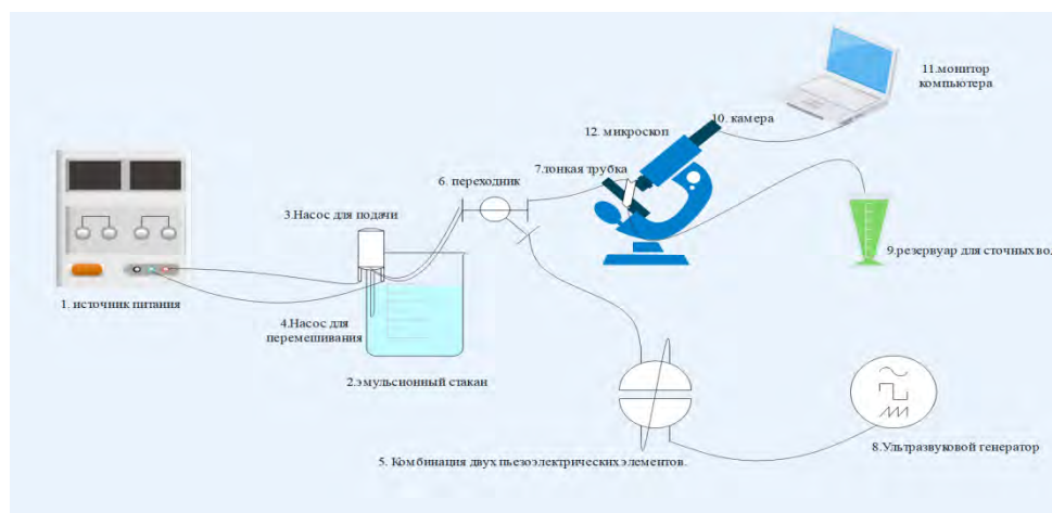
Рис. 1. Схема эксперимента по ультразвуковой деэмульсации
