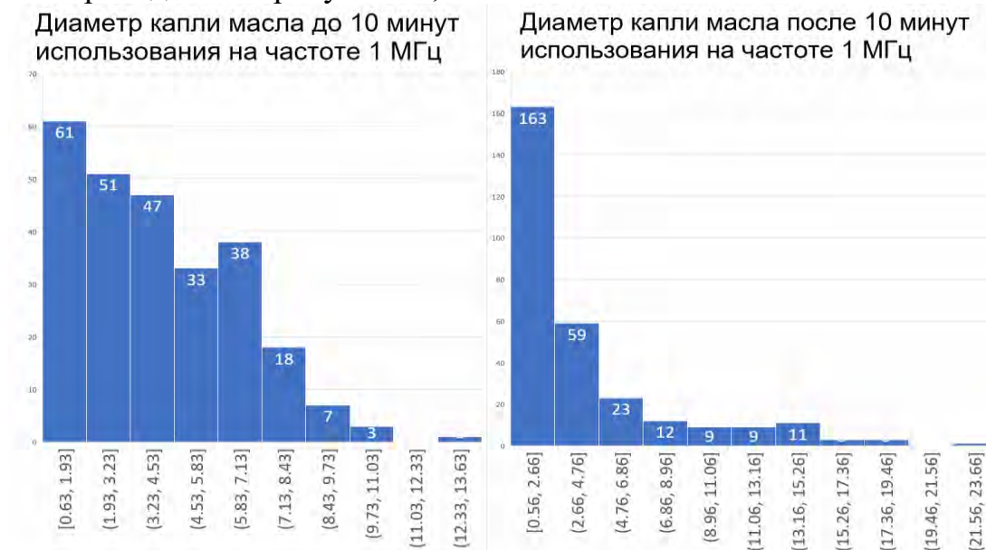
Рис. 5. Распределение капель масла в эмульсии в начале и конце при 1 МГц (Ручная маркировка)
