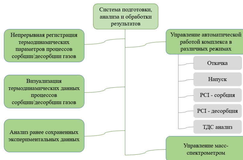
Рисунок 2.4 – Состав системы подготовки анализа и обработки результатов программно-аппаратного комплекса GRAM50
