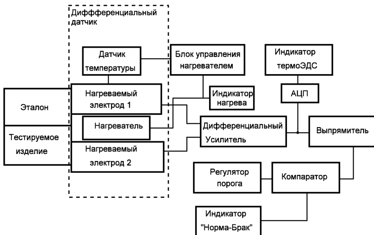
Рисунок 6.3 – Структурная схема прибора термоэлектрического контроля «Термотест-1»
