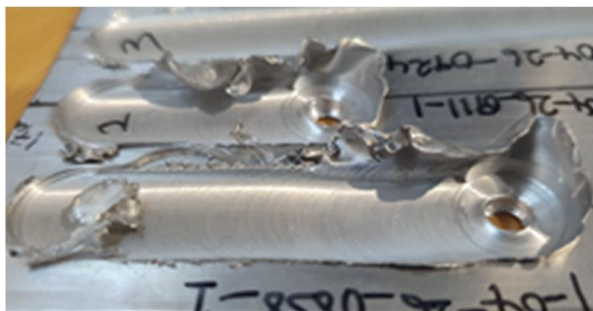
Рисунок 1.13 – Результат приложенного высокого усилия нажатия на свариваемые детали
