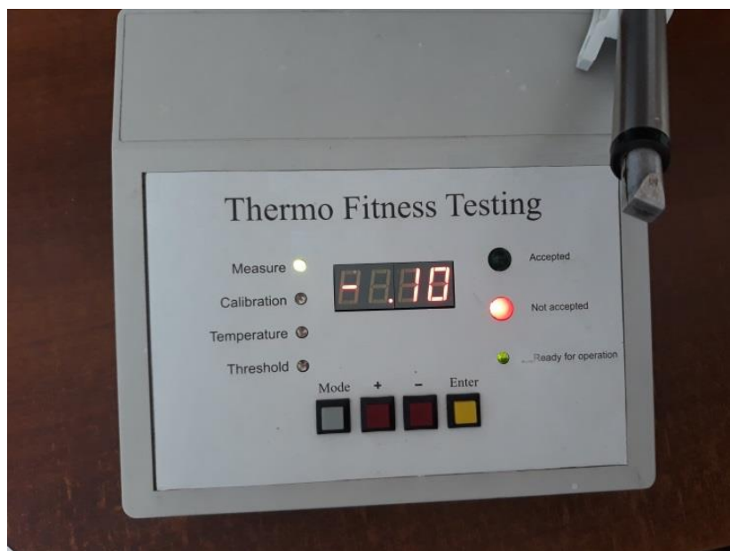
Рисунок 6.12 – Фотография прибора термоэлектрического контроля «Thermo Fitness Testing»
