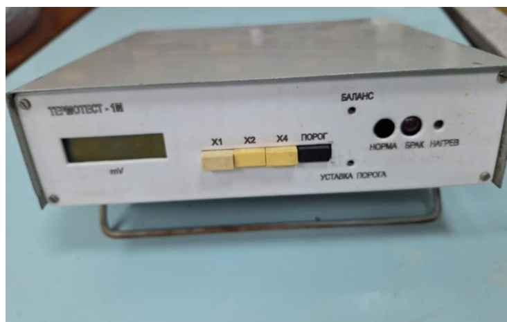
Рисунок 6.1 – Прибор термоэлектрического контроля металлов и сплавов «ТЕРМОТЕСТ-1М»
