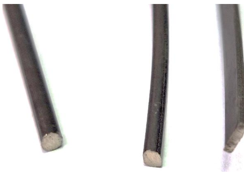
Рисунок 3.1 – Экспериментальные образцы термопар, левый – без деформации, средний – деформация 17 %, правый – деформация 33 %
