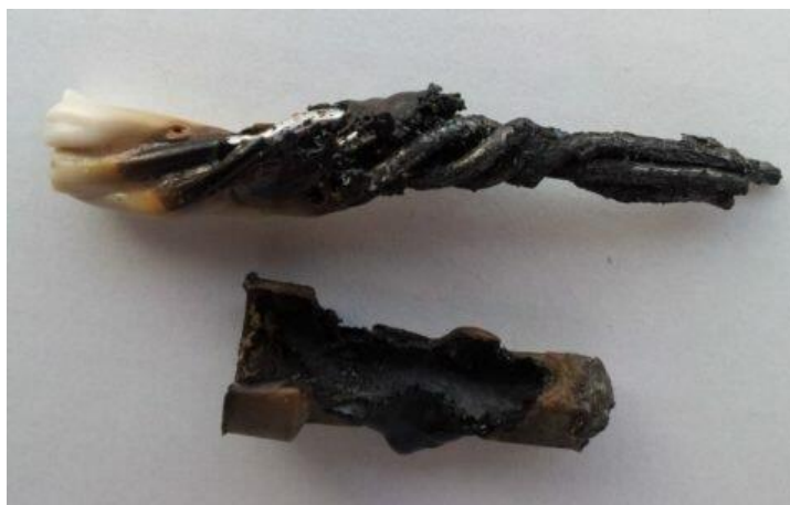
Рисунок 1.11 –Последствия воспламенения из-за большого переходного сопротивления при соединении проводников методом скрутки
