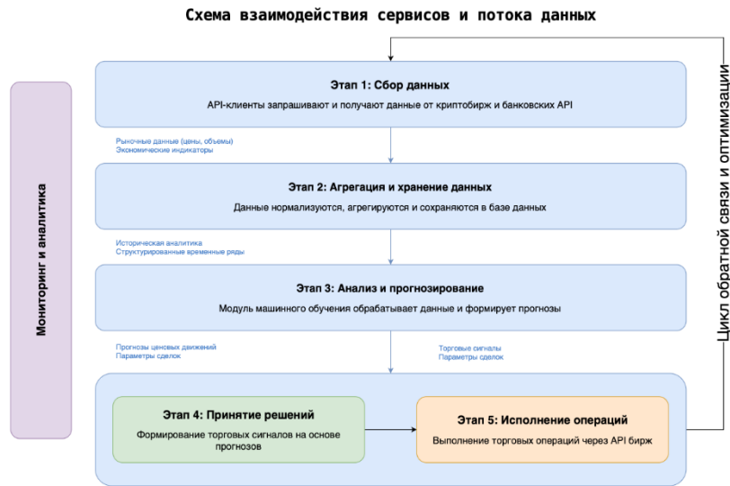
Рис. 2. Схема взаимодействия сервисов и потока данных
