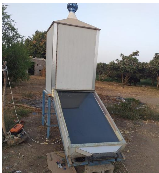
Рис. 1. Фотография экспериментальной установки и схема солнечной сушилки Fig. 1. Photograph of the experimental setup and scheme of the solar dryer
