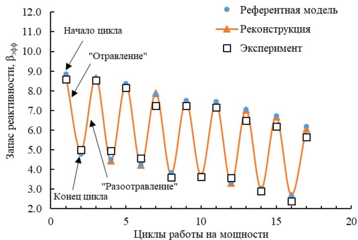
Рисунок 2.22 – Оценка стабильности модели с реконструированным составом топлива при моделировании рабочих циклов
