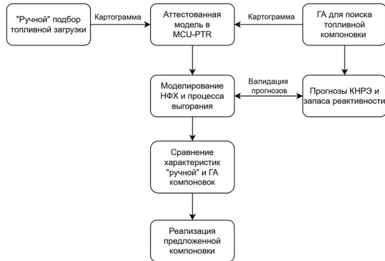
Рисунок 4.9 – Блок-схема опытной эксплуатации ГА с прогнозными моделями
