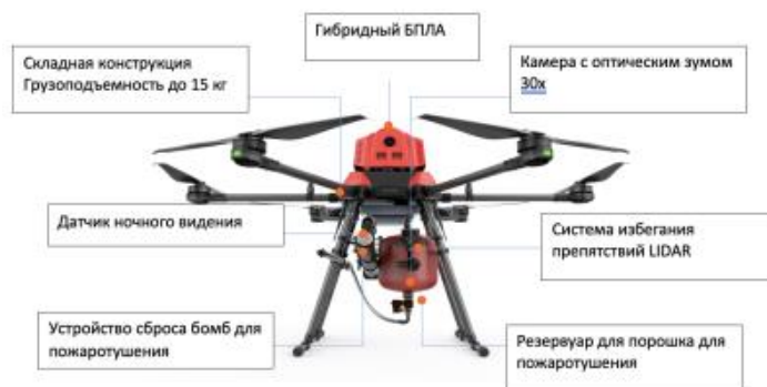
Рис. 1. Устройство гибридного БПЛА с порошковой системой пожаротушения
