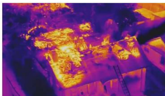
Рис. 2. Кадр пожарной обстановки с тепловой камеры, установленной на БПЛА
