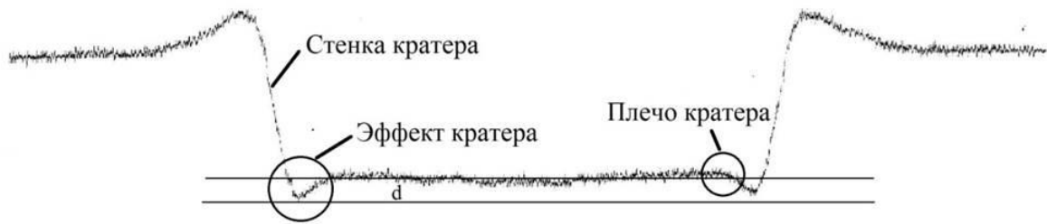
Рисунок 2.10 – Схематическое представление кратерного рельефа с обозначением глубины ( d ) как перепада высот между бровкой и центром впадины
