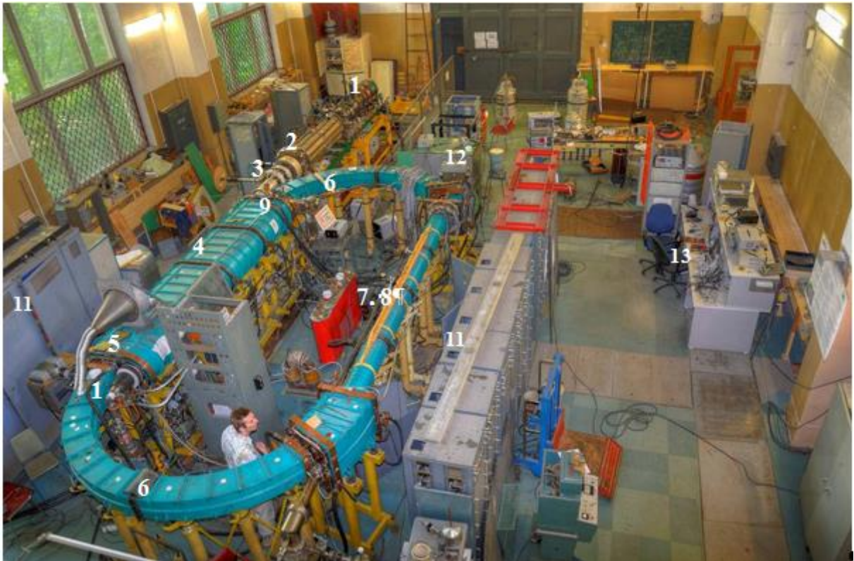
Рисунок 2.4 – Схема экспериментального комплекса с позитронным пучком ЛЯП ОИЯИ [161]: 1 – источник позитронов; 2 – накопительная ловушка; 3 – инжекционный канал; 4 – септумные соленоиды; 5 – кикерная система; 6 – тороидальные соленоиды; 7 – соленоидно-квадрупольный транспортер; 8 – секция электронного охлаждения; 9 – электронная пушка; 10 – коллектор электронов; 11 – система электропитания; 12 – экспериментальная станция; 13 – центральный пульт управления
