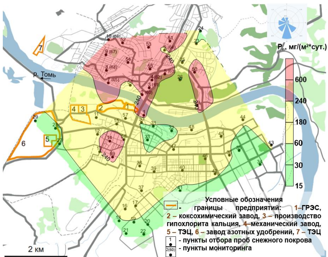
Рисунок 1 – Карта-схема распределения пылевой нагрузки на территории г. Кемерово по данным снеговой съемки («роза» ветров за зимний период, градация на шкале – Таловская, 2022)
