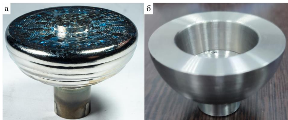
Рисунок 13 – Напечатанное изделие аддитивной технологией (а), после токарной обработки (б)
